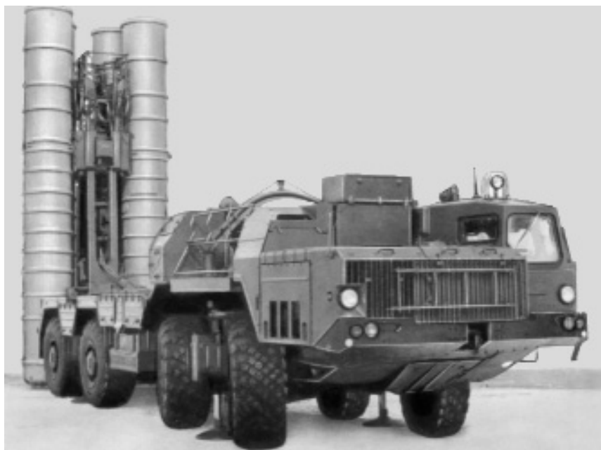
С-300П. Пусковая установка с четырьмя ракетами в транспортно-пусковых контейнерах.
